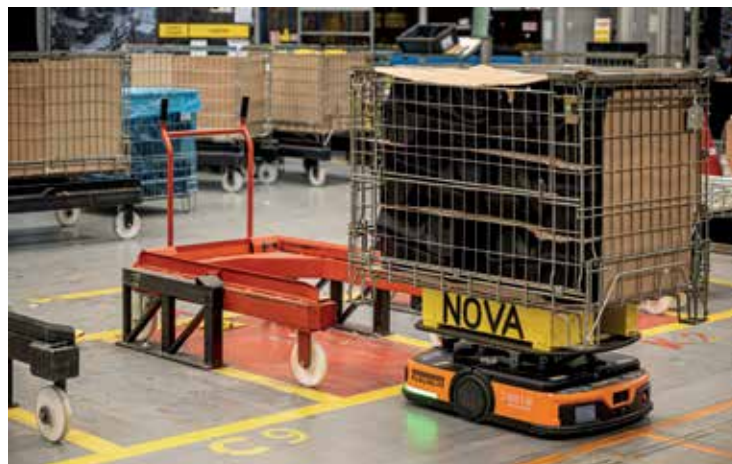
L'obiettivo della soluzione realizzata con Robomove era: automatizzare al 100% i flussi di messa a stock dei semilavorati prodotti internamente
